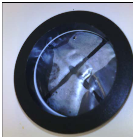
Figure III-6: Testeur de débit de transmission de vapeur d'eau à travers le film
