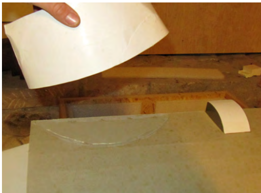
Fig 86 Detalle de pieza descolada
