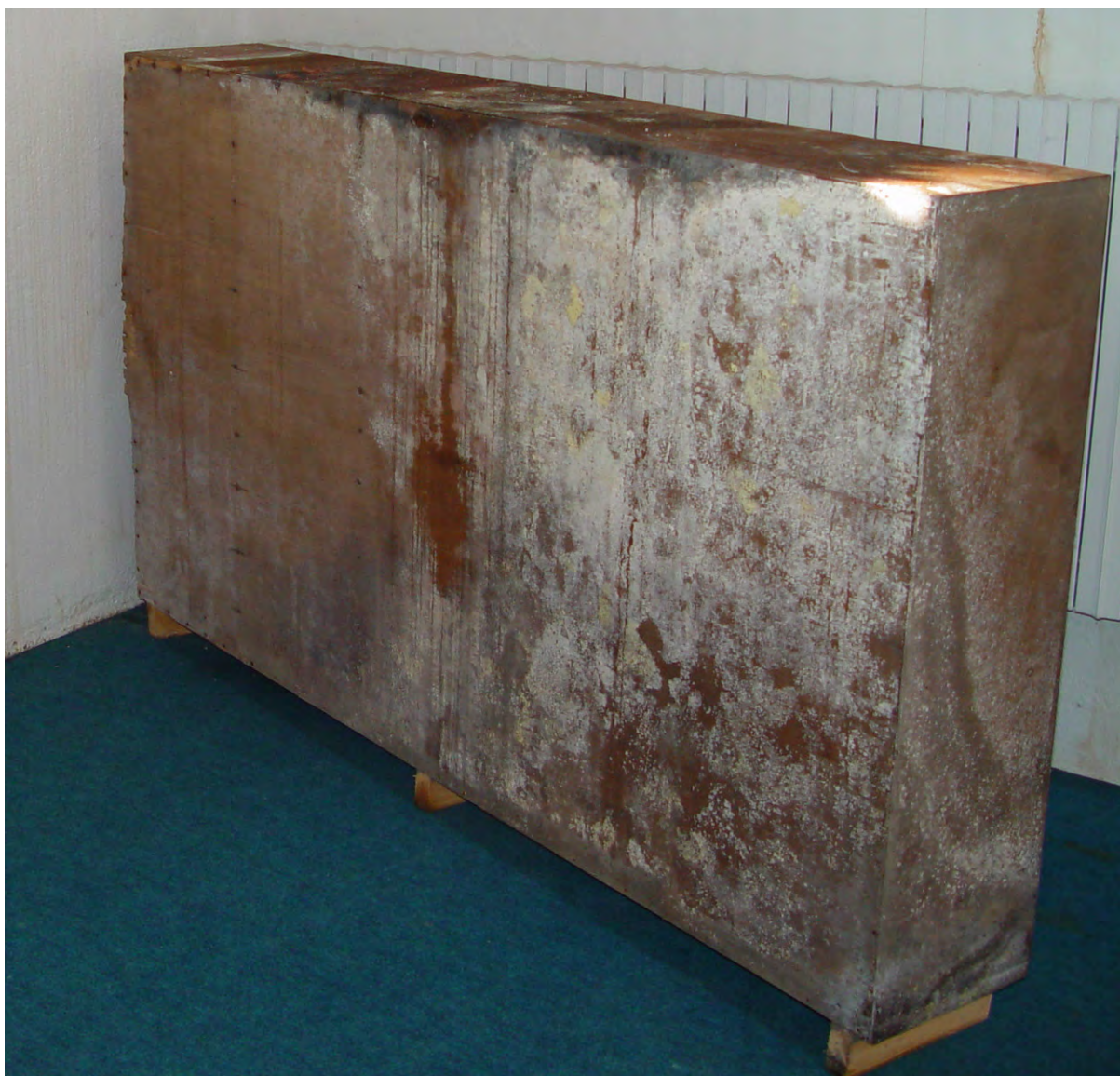
Fig 4 Vista de la trasera de baldas con ataque de hongos
