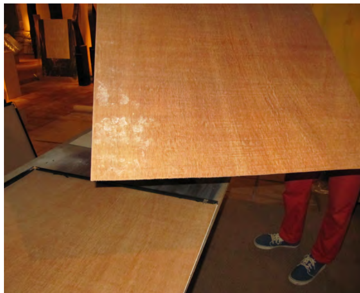
Fig 68 Trasera de madera con signos de hongos por humedad
