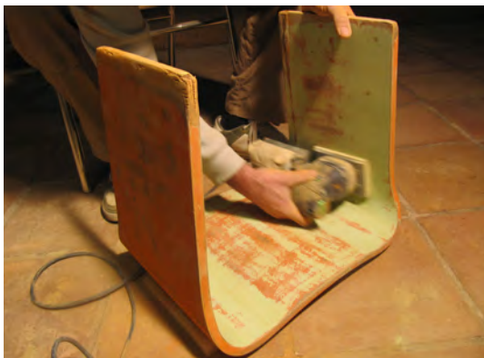
Fig 106 proceso de lijado
