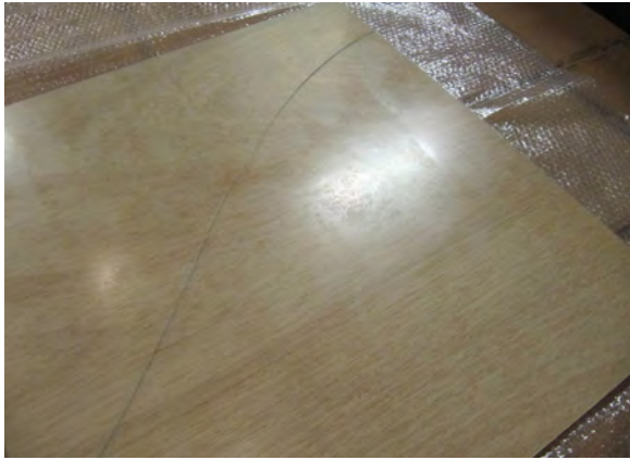
Fig 64 Rotura de un cristal de enmarcado
