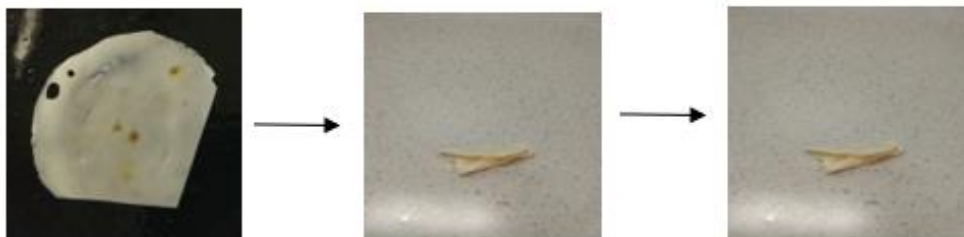
Figura 1.12. Imágenes del proceso de fijación/ recuperación de forma de un material sin memoria de forma.
