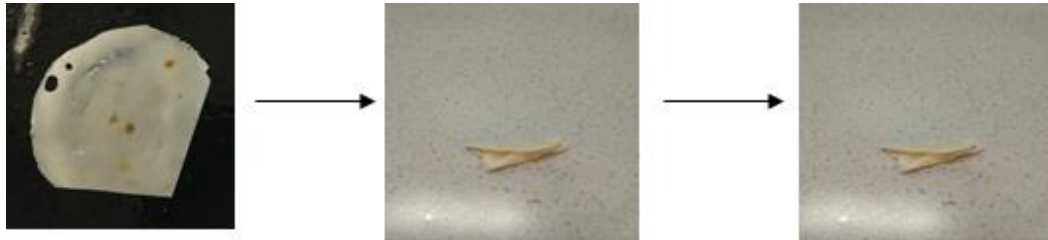
Figura 4.7. Comportamiento del material en un ensayo de memoria de forma.
