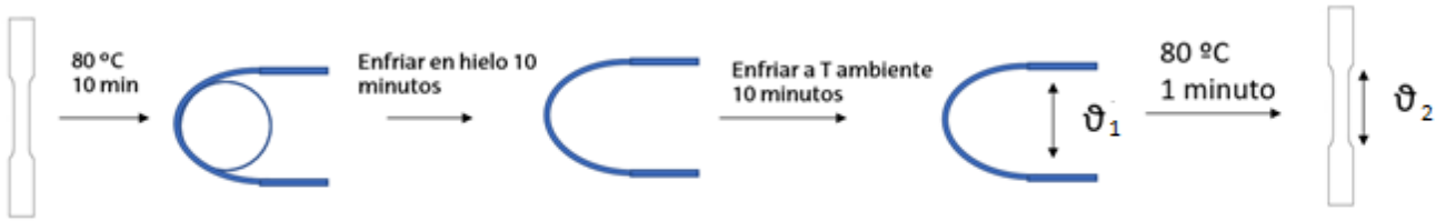
Figura 2.6. Ensayo manual para el agente de curado DSS.
