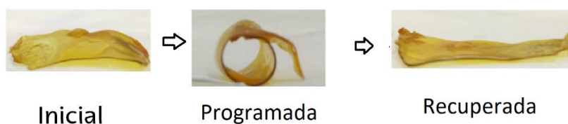
Figura 4.32. Ensayo de memoria de forma para una composición 0/100 DDM/DSS y 50/50 epoxi/PCL.
