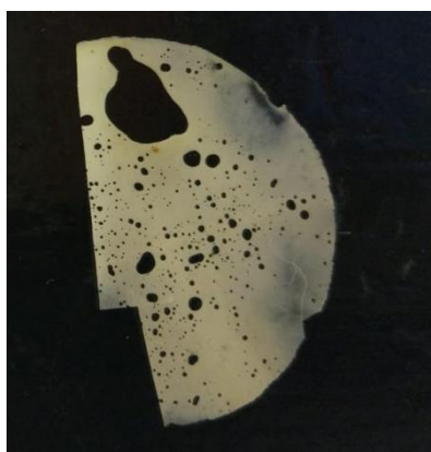
Figura 4.2. Aspecto de una mezcla DGEBA/PC en proporciones 85/15 curada con DDS.
