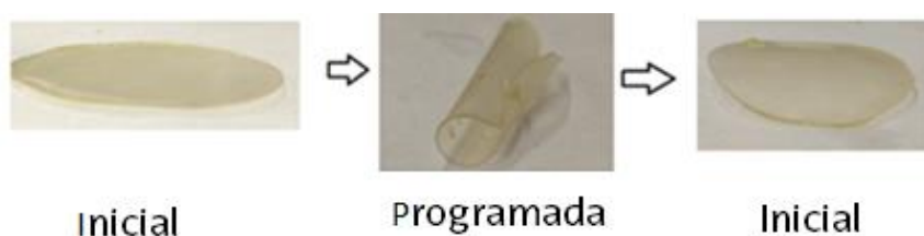
Figura 4.20. Ciclo de memoria de forma para la composición 50/50 DGEBA /PCL con DDM.
