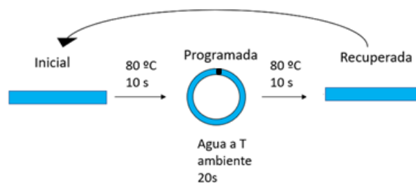
Figura 2.4. Ciclo al que es sometida la muestra para establecer la memoria de forma de modo visual.
