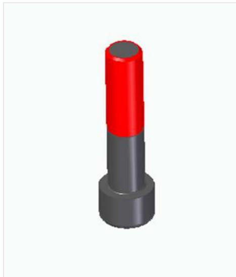
*Imagen 47. Tornillo cabeza cilíndrica con hueco hexagonal*
