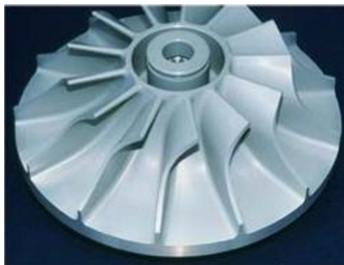
Figura 37. Turbina radial convencional.
