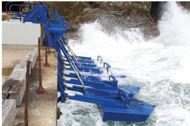
Figura 22. Otro tipo de Absorbedor puntual con fijación externa que aprovecha el movimiento del mar. Fuente: Eco Wave Power.
