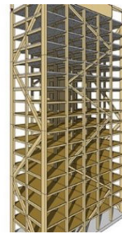
Estructural celosía tipo tubo: Mjøstårnet
