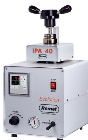
Irudia VI.16: Remet IPA 40 Evolution kapsulatze-zentroa
