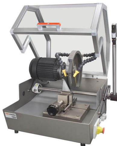
Irudia VI.14: Remet TR100 Evolution zerra metalografikoa
