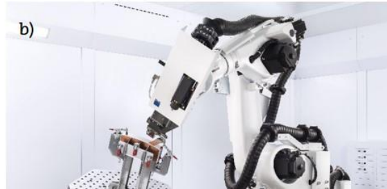
Irudia II.50: Laser-makineria: roboten eta laserren arteko akoplatzea (a: KUKA; b: Trumf)
