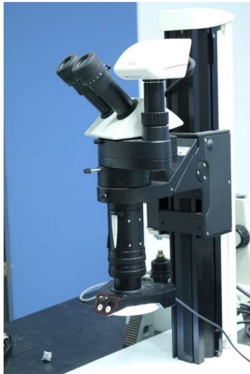
Irudia VI.18: Leica Z6 APO mikroskopia eta Leica DFC 295 kamera digitala
