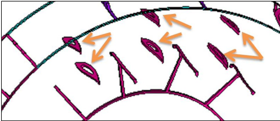
Irudia III.12: TBHaren bao estrukturalen soldadura guneak
