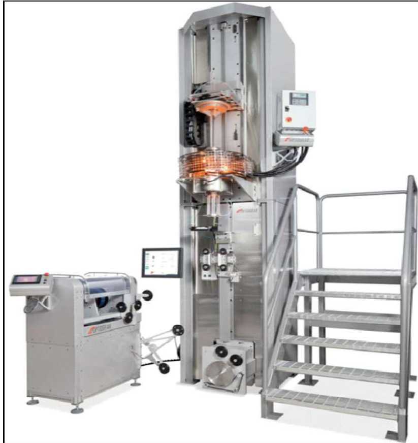
Figura 5. Torre de estirado del Grupo de Investigación “Applied Photonics Bilbao”.
