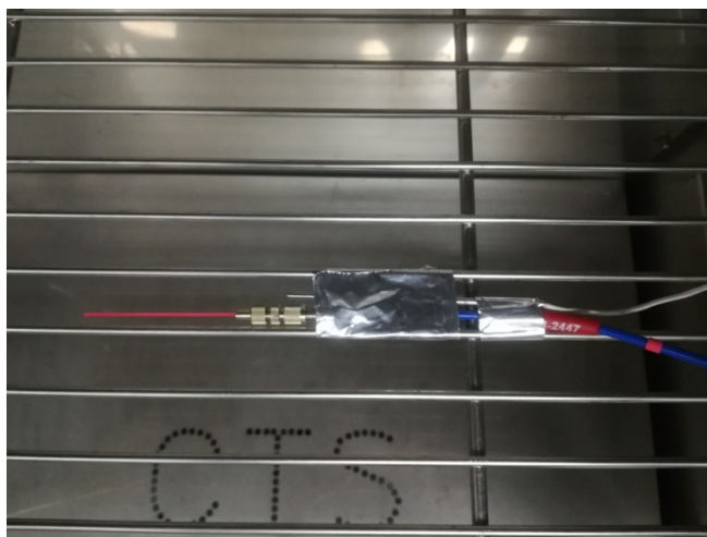
Figura 14. Detalle de la disposición en el horno del termopar y la fibra.
