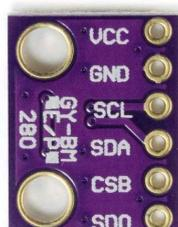
Figura 17. Sensor de presión barométrico
