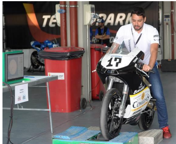
Ilustración A4: prueba de comprobación de frenos.
