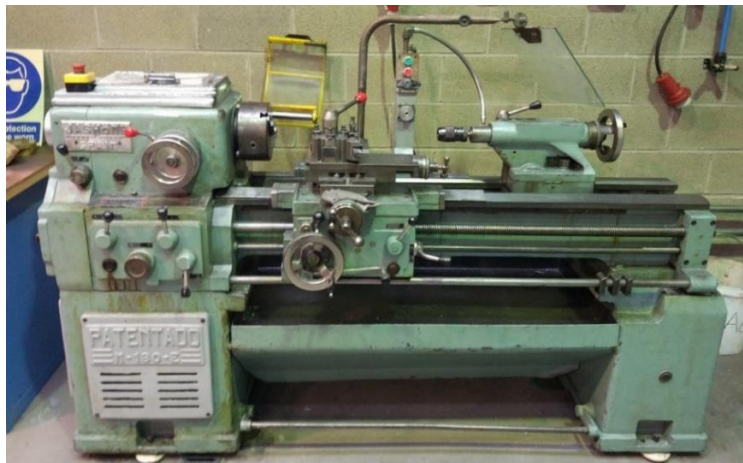
Ilustración 8: Torno manual Jashöne M180E.
