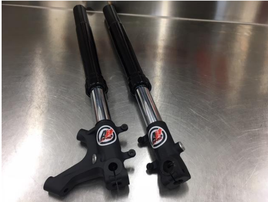
Ilustración B4: horquilla de la suspensión delantera Andreani MHS.
