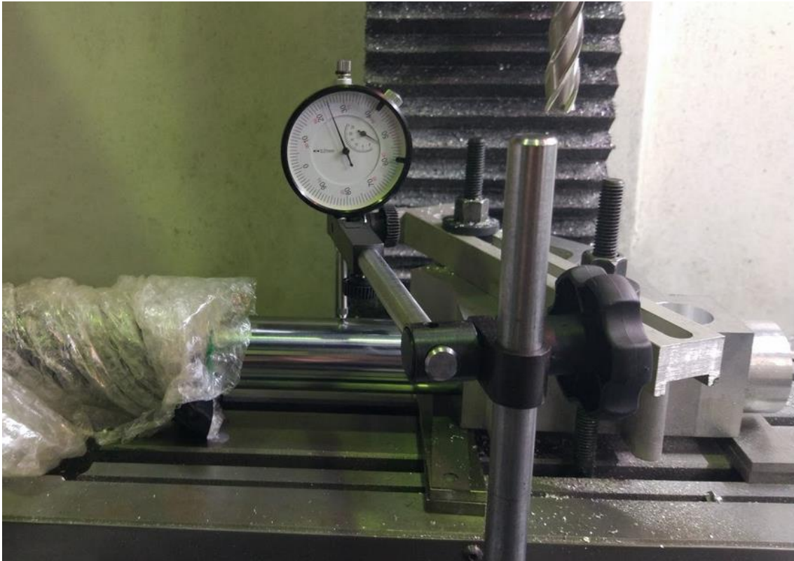
Ilustración 82: midiendo la desviación en z con el reloj comparador.
