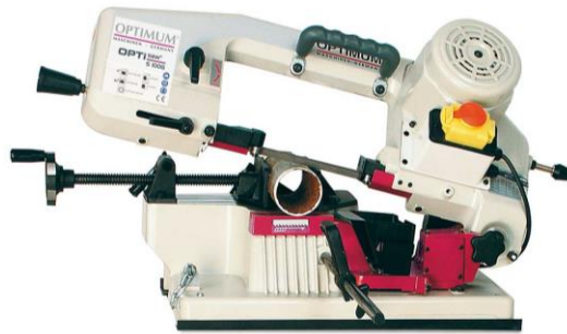
Ilustración 7: Sierra de cinta Optimum S 100 G.
