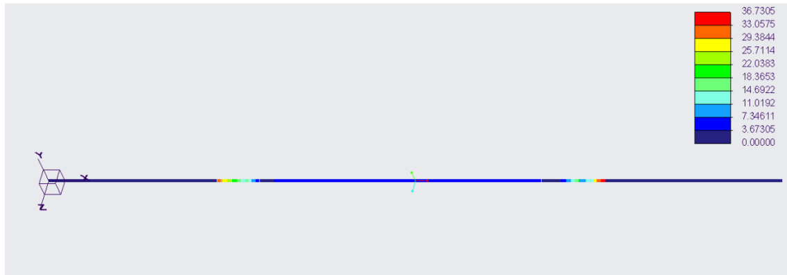
Ilustración 45: tensiones en el eje delantero.
