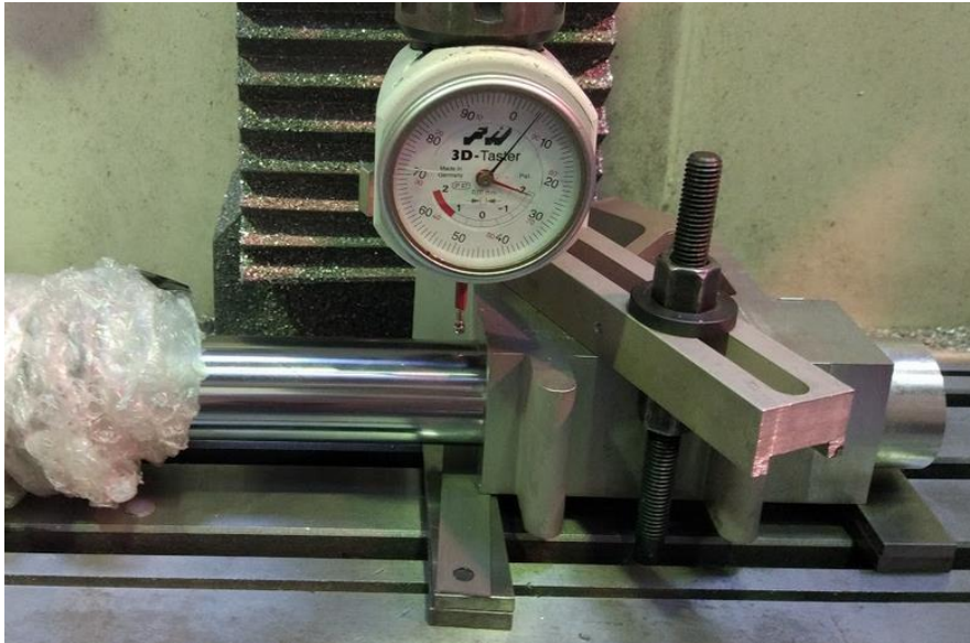
Ilustración 83: cogiendo las referencias con el palpador.
