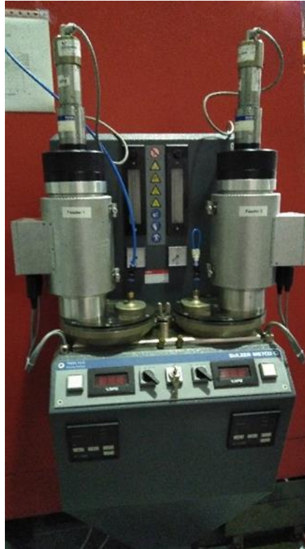
Ilustración 30. Alimentador de polvo Sulzer Metco Twin 10-C
