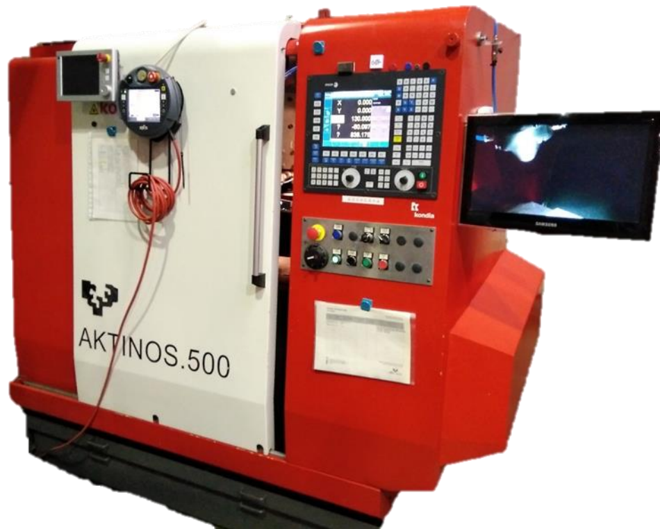
Ilustración 32. Centro de fabricación aditiva Kondia Aktinos 500
