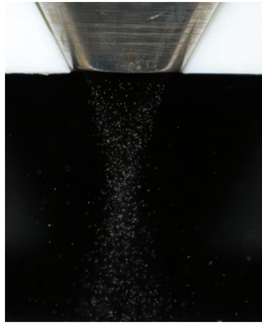
Ilustración 36. Distribución uniforme de polvo
