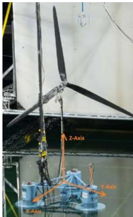
2-13 irudia. MARINeko olatu-andelean testatu zen haize-turbina erdi-urperagarriaren (DeepCwind semisubmersible) maketa [8].
