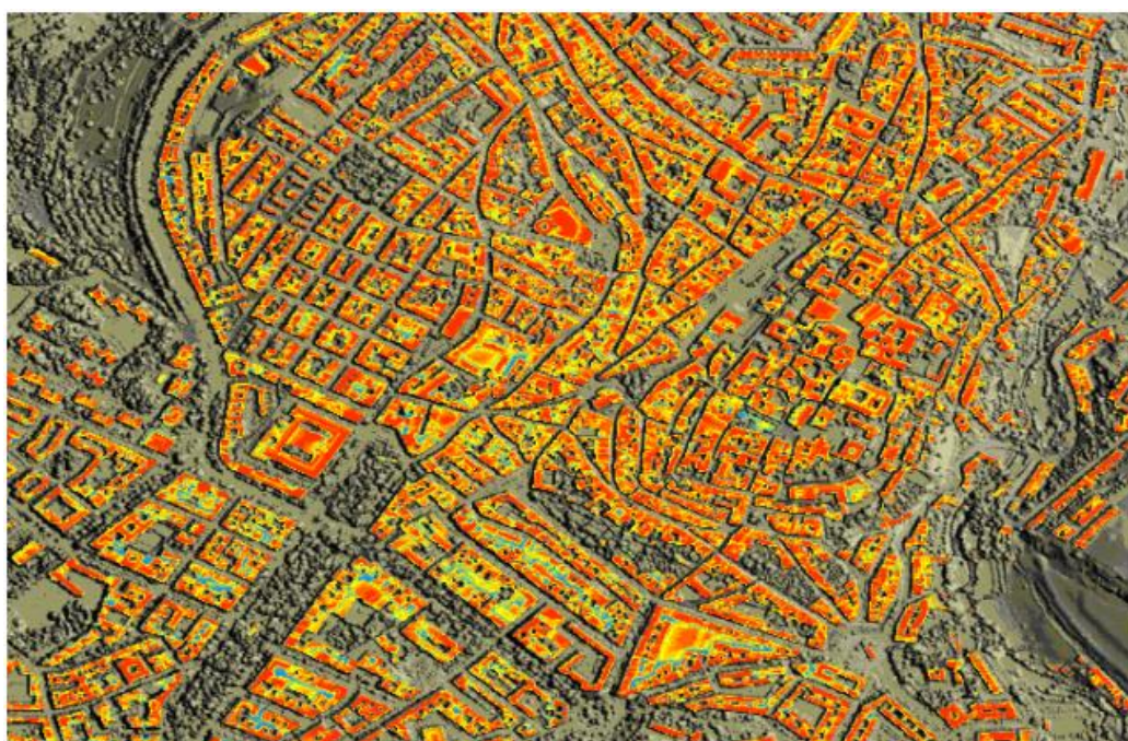
Irudia 2-1: Teilatuen Eguzki potentzial fotovoltaikoa LIDAR datuen gainean.
