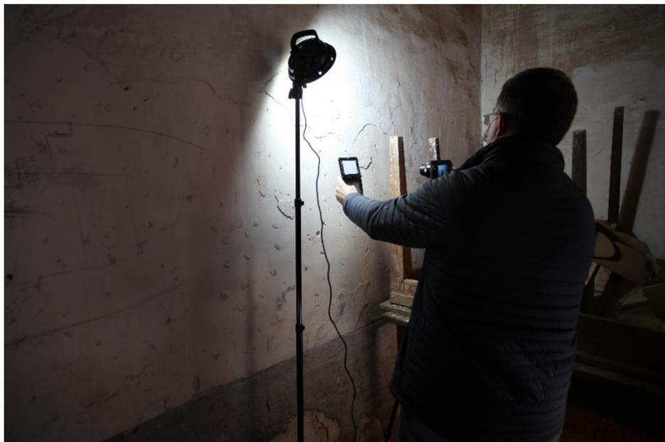
Figura 25. Ajuste en campo del «balance de blancos» con el fin de obtener unas fotografías con un tono de iluminación correcto.
