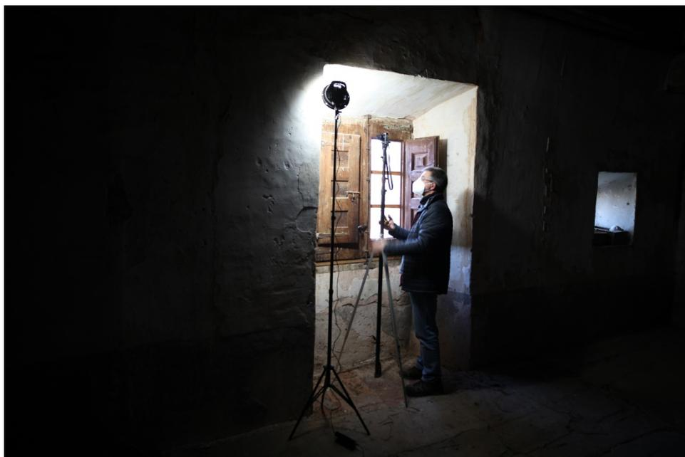
Figura 24. Colocación de la cámara sobre jalón telescópico para fotografiar un grafito situado a unos 2'2 metros del suelo, también se aprecia uno de los dos focos de iluminación utilizados, colocado de forma que la incidencia de luz rasante hiciese destacar los trazos a representar.
