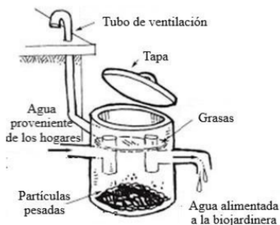
Figura 14. Esquema del tratamiento primario o trampa de grasas. Fuente: Urkijo (2019).
