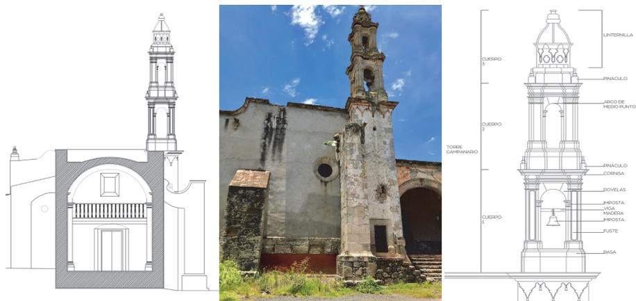
Figura 8. Torre campanario de la capilla y arbotante invertido. (Fuente: Elaboración propia).
