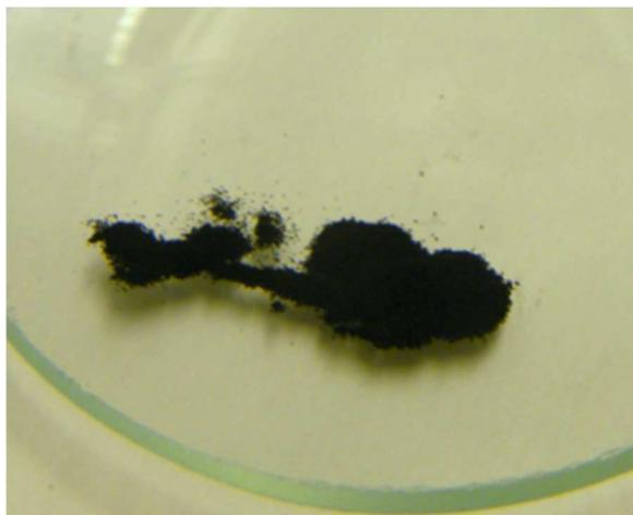
Figura 50. Aspecto del catalizador de Ni/Al<sub>2</sub>O<sub>3</sub> tras los ensayos
