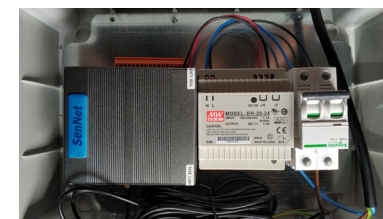
22. Irudia. Monitorizazio ekipoa: SenNet DR-30-24 datalogger-a. Iturria: egilea.
