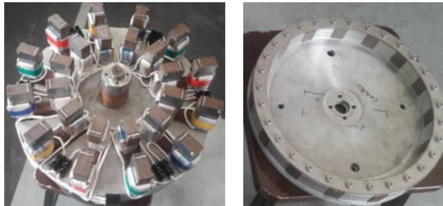
(a) Estátor bobinado con núcleos en forma de U. (b) Rotor de la máquina.
