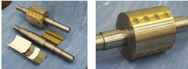
(a) Detalles de construcción de una SynRM laminada.      (b) Vista del rotor ensamblado de una SynRM laminada.
