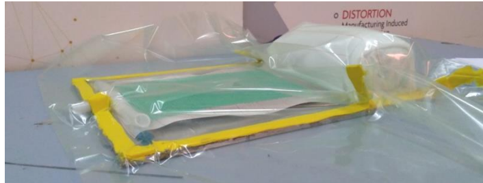
43. Irudia. VARTM bidez material konposatua fabrikatzeko muntaiaren azken itxura.
