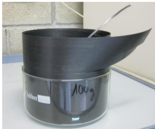
27. Irudia. Prepreg-hondakina erreaktorera sartu aurretik.
