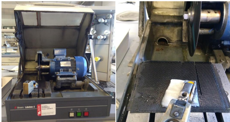
47. Irudia. Struers Labotom-3 diskodun ebakitzaillearen itxura.
