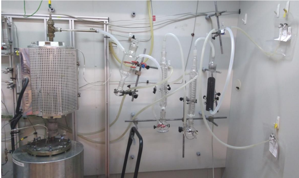
33. Irudia. Pirolisi-planta pilotuaren argazkia.
