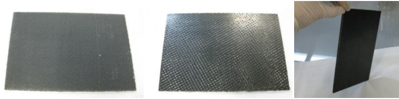
28. Irudia. Karbono-zuntzeko material konposatu onduaren itxura.
