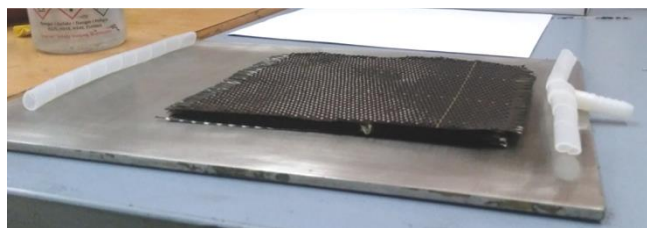
39. Irudia. Plaka metalikoa, karbono-zuntz ehunen, hodi elikoidal eta sarrera-piezaren itxura.
