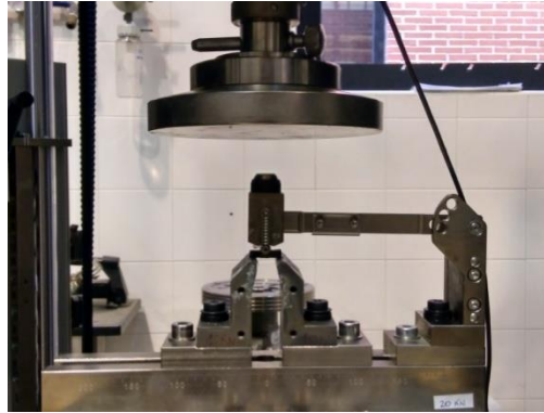
50. Irudia. Lamina arteko ebakidura erresistentzia neurtzeko saiakuntza-muntaia.
