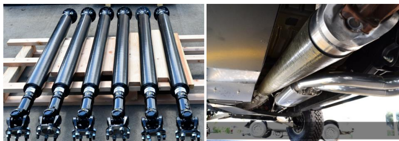
11. Irudia. Pultrusioaren bitartez ekoiztutako material konposatuz egindako autoen transmisio-ardatzak.
