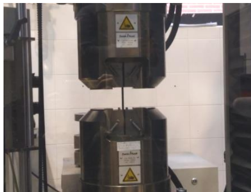
51. Irudia. Trakzio-saiakuntza makinaren itxura.
