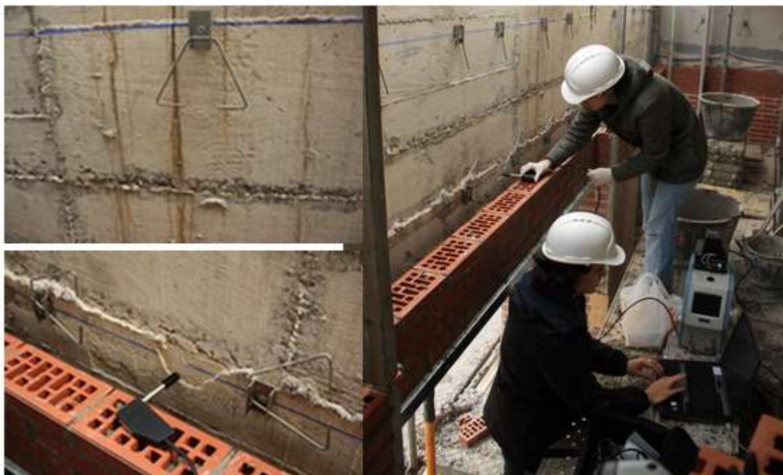
Figura 4.3: imágenes del hormigón armado de Donostia tomadas sobre el andamio donde se aprecian los detalles de las zonas analizadas junto con el equipo Raman portátil.
