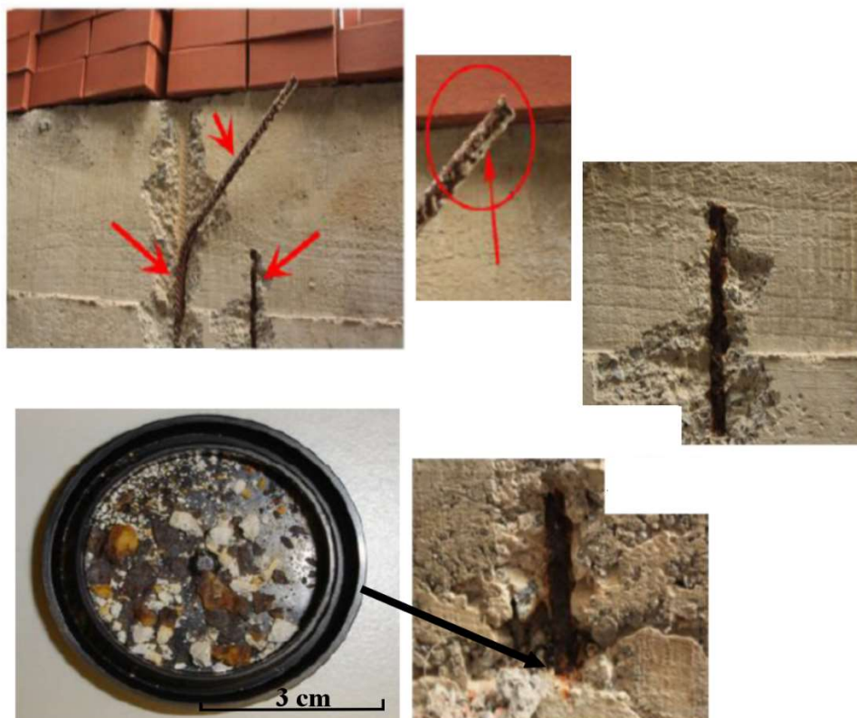
Figura 5.2: imágenes in situ y detalles de las muestras de acero recogidas en Donostia
