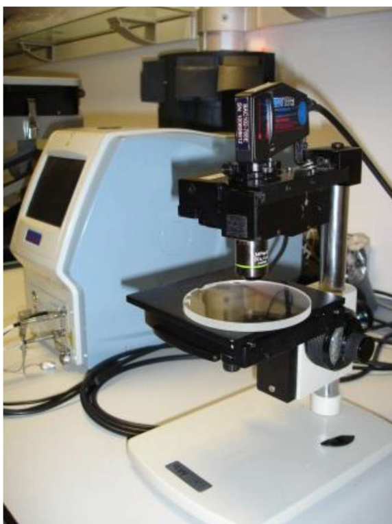
Figura 3.15: Imagen del espectrómetro Raman portátil innoRamTM y de la microcámara acoplada al microscopio de enfoque manual.
