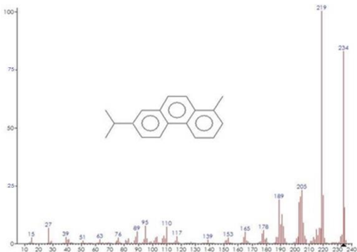
Fig 8. Espectro de masas de referencia del reteno y su estructura.
