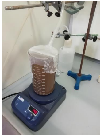
9. Irudia: NaOHren desoxigenazioa \text{N}_2 atmosferapean burutzeko erabilitako muntaia.
