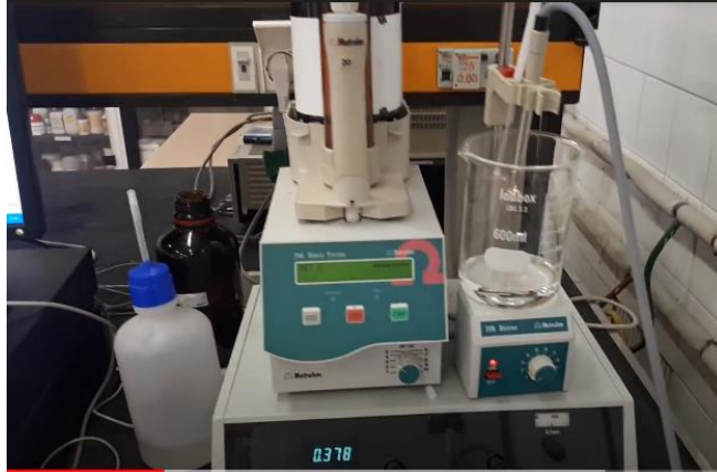
3. irudia. Basic Titrino 794 bureta automatikoa zuntz optikoarekin
