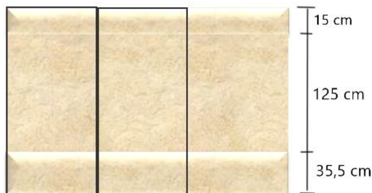
Figura 3.7. Medidas y colocación de los tres componentes del zócalo.
