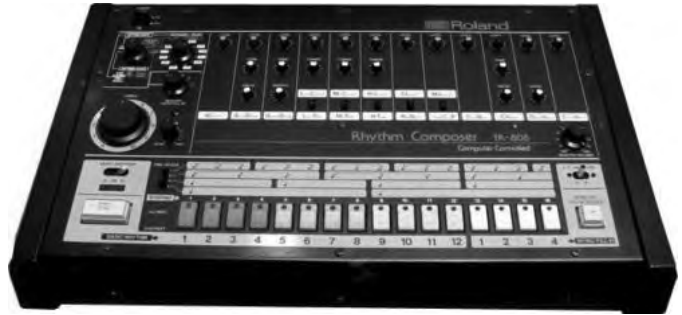
Figura 2. Roland TR-808 Rhythm Composer. La Roland TR-808 Rhythm Composer fue una de las primeras cajas de ritmo programables (“TR” era la abreviatura de Transistor Rhythm ). Introducida por Roland Corporation en 1980, fue concebida originalmente para la creación de demos por músicos de estudio. Como cajas de ritmos de Roland anteriores, su sonido no se asemejaba al de una batería real. Debido a que la TR-808 apareció unos meses después de la Linn LM-1 (la primera caja de ritmos en usar samples digitales), los profesionales generalmente la consideraban inferior en cuanto a la calidad de los sonidos. Sin embargo, el precio de la TR-808 en el momento de su lanzamiento (1.000 $) era considerablemente más asequible que los 5.000$ de la LM-1. Wikipedia. 15/09/2017.
