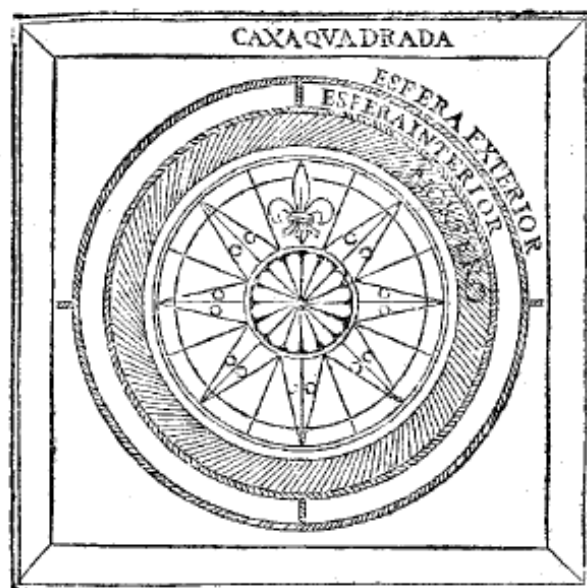
Figura 5.23. Partes más importantes de la aguja de marear. Fuente: Zamorano, 1581, fol.36 verso.
