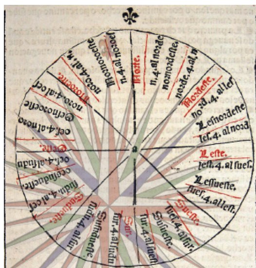
Figura 5.16. Cuarteo de la rosa de los vientos. Fuente: Medina,1552, fol. s.n.
