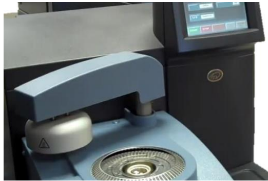
Figura 35. Equipo DSC Q200 Modulado de TA Instruments
