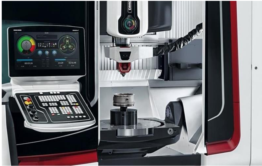
Figura II-27. Máquina híbrida LASERTEC 65 3D de la empresa DMG Mori: Aporte láser DED y fresado en 5 ejes.
