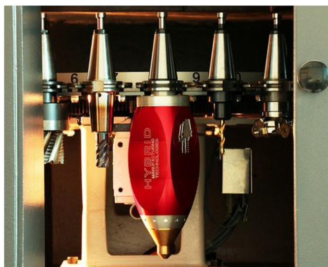
Figura II-25. Cabezal láser intercambiable AMBIT™. Fuente: Hybrid Manufacturing Technologies [H.M.T.-b, 2020].
