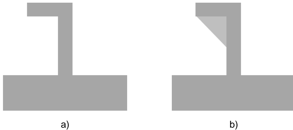
Figura V-3. Preforma para obtener la geometría tras mecanizar: a) Geometría objetivo; b) Preforma para la obtención de la geometría tras el mecanizado.
