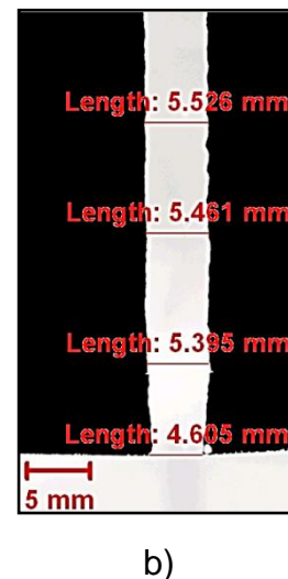
Figura III-66. a) Esquema para el cálculo de la anchura total de la pared; b) Incremento de la anchura de la pared hasta alcanzar un valor constante.
