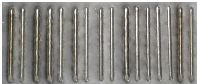
Figura III-36. Cordones aportados con la boquilla coaxial continua de 0,5 mm.
