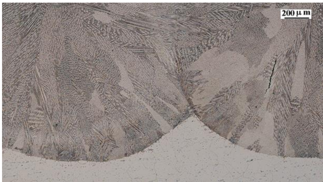
Figura II-8. Grieta en recubrimiento de base níquel Colmonoy 56P2 sobre acero 42CrMoS4 sin precalentar.
