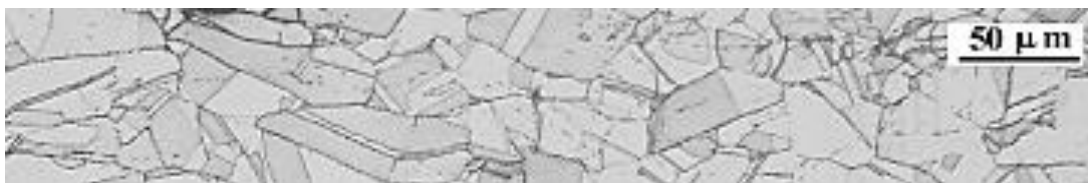
Figura III-6. Estructura de la placa forjada ATI 718.
