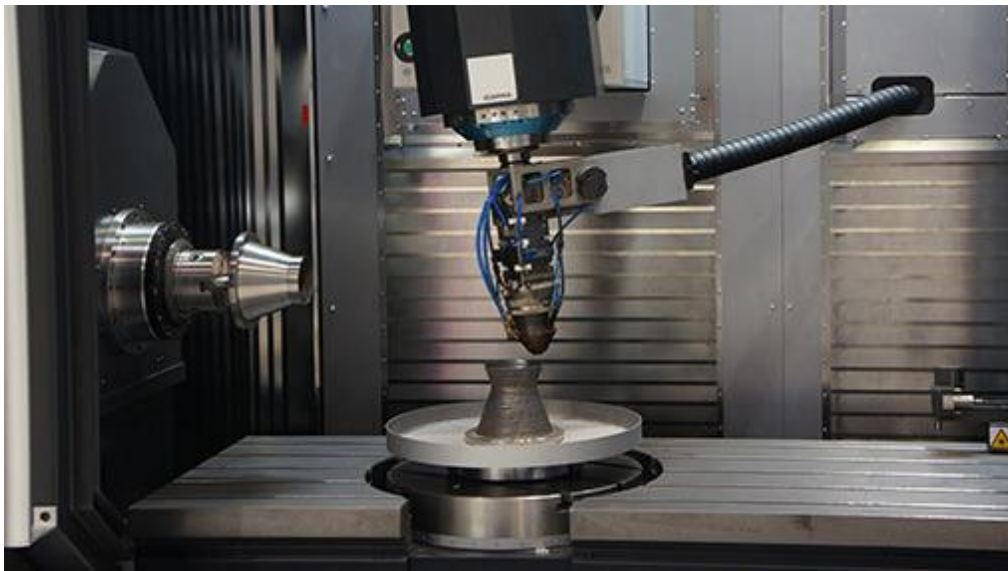
Figura II-26. Máquina híbrida ZVH Add+Process de la empresa Ibarmia: Aporte láser DED y mecanizado multiproceso en 5 ejes.
