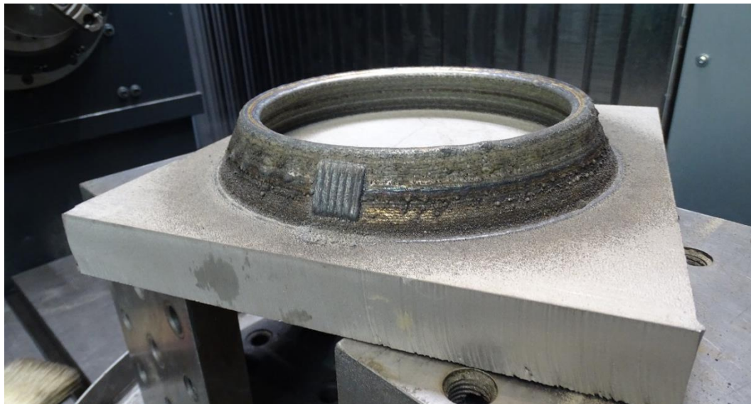
Figura VI-2. Geometría de revolución y detalle aportado a 60^\circ respecto de la horizontal.
