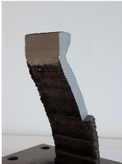
Figura V-16. Imagen de la geometría tras el proceso de corte por agua y mecanizado. No se perciben defectos.
