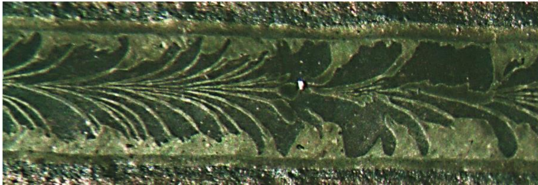
Figura II-7. Marcas de enfriamiento siguiendo el gradiente de temperatura en AISI 316L.
