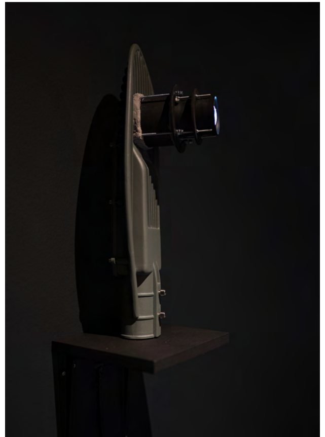
Luminaria con un gran disipador, tubo de metal, gobo de metal, lente y anclajes creada para Light, Water; Ganzfeld. 2019
