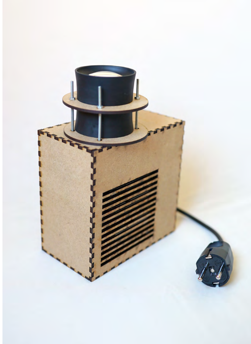
Dispositivo realizado con cortadora láser. Led, disipador, transformador, gobo y lente.
