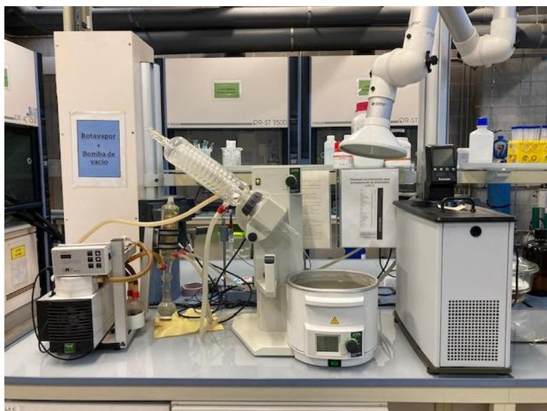
**Figura 1.** Equipo de vacío, rotavapor y refrigerador empleados durante la impregnación húmeda de los catalizadores.
