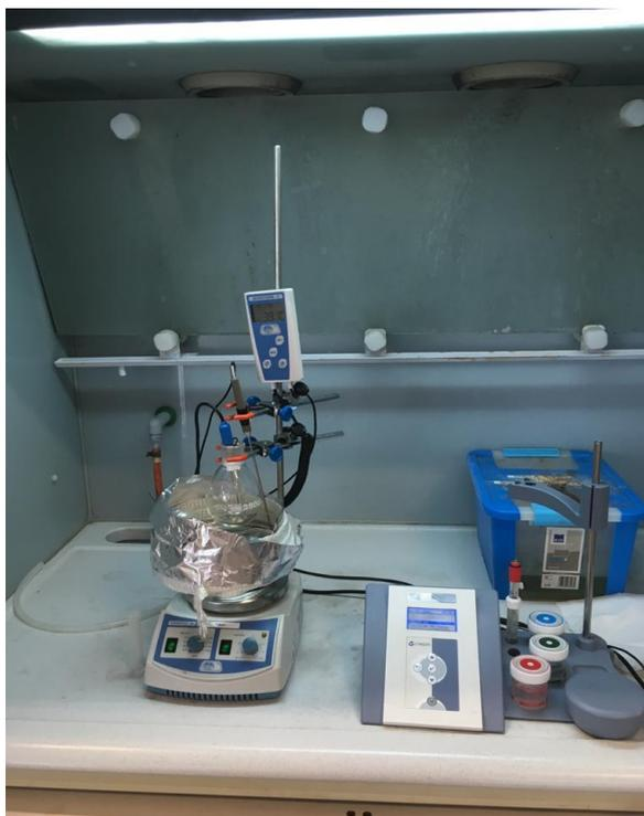
**Figura 2.** Instalación para la preparación de catalizadores de las series  $35\text{Cu}^{\text{Cl}}\text{Co}^{\text{Cl}}_{[\text{X}]}$  y  $35\text{Cu}^{\text{N}}\text{Co}^{\text{N}}_{[\text{X}]}$ .
