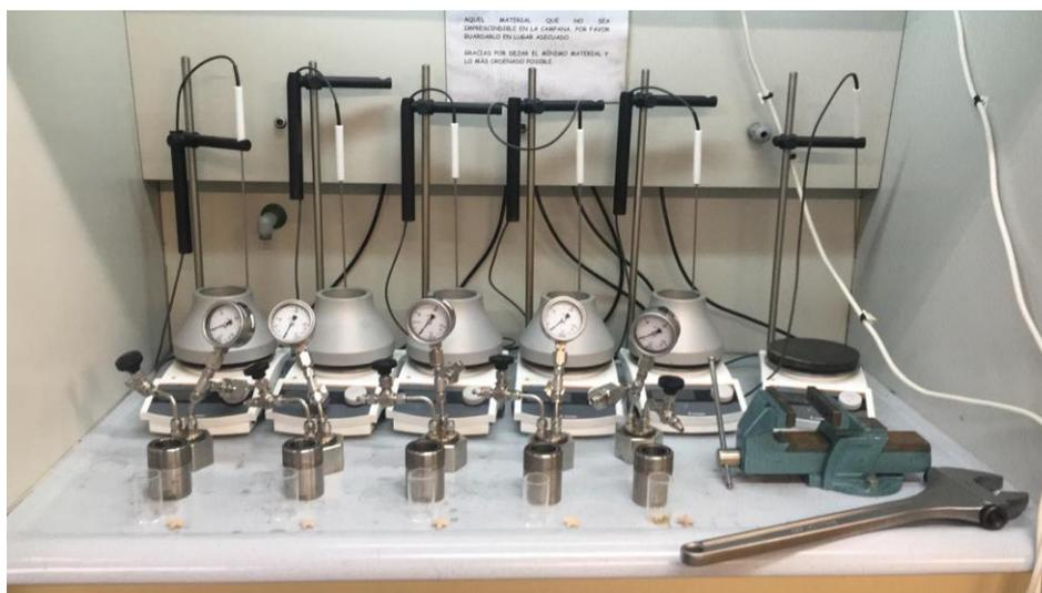
**Figura 5.** Reactores discontinuos, placas calefactoras y cuerpos térmicos de aluminio utilizados para ejecutar los ensayos de actividad.
