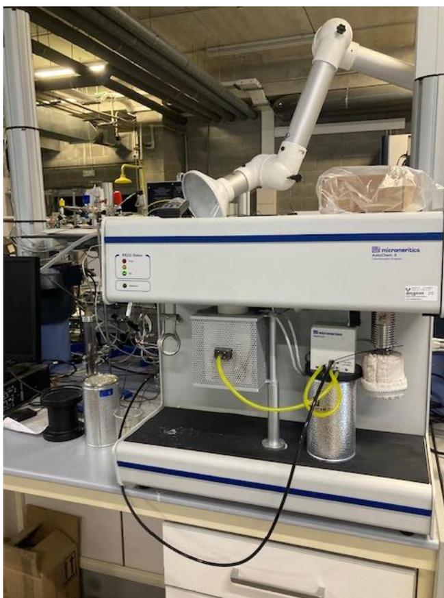
**Figura 7.** Equipo Autochem II (Micromeritics).
