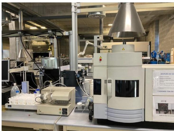
**Figura 6.** Equipo ICP-OES PERKIN Elmer Optima 2000 OV.
