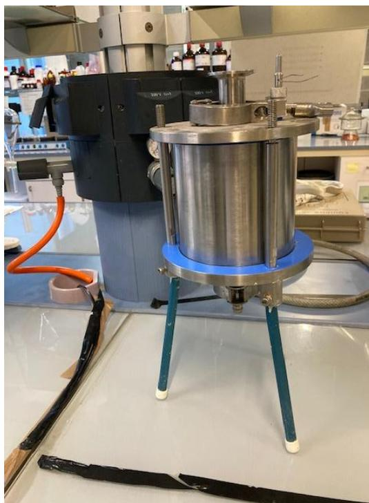
**Figura 4.** Dispositivo de filtración a presión.
