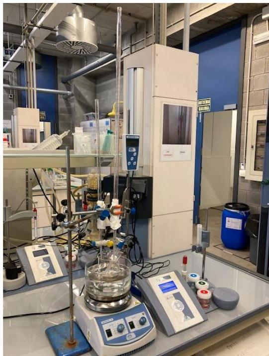
**Figura 3.** Montaje para la titulación de las disoluciones de síntesis durante el protocolo de preparación de los catalizadores derivados de hidrotalcita.
