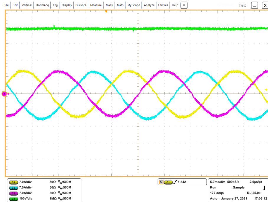
6.15. Irudia: Sarrerako korrante trifasikoaren eta irteerako tentsioaren uhinformak.
