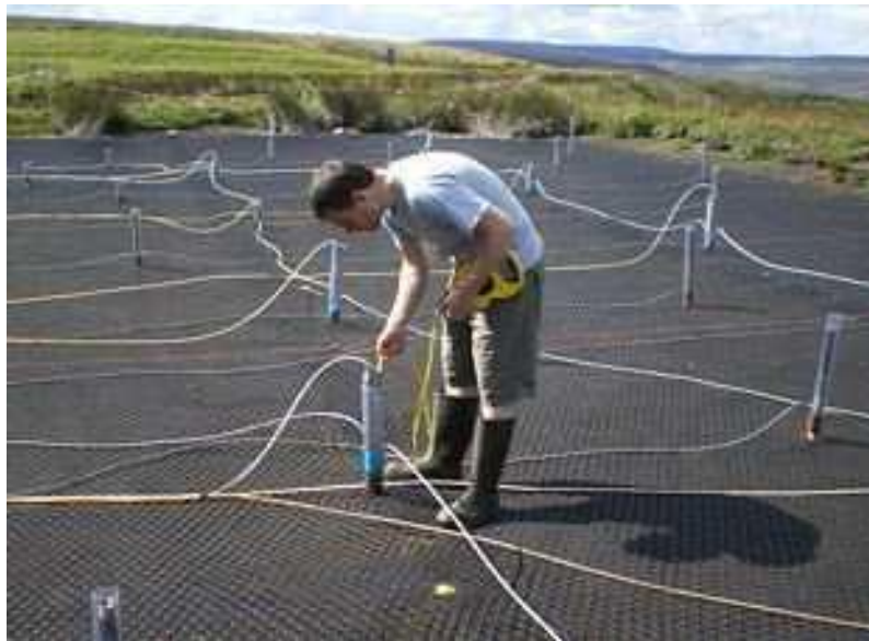
Figura 1.6. Remediación electrocinética del suelo [30].
