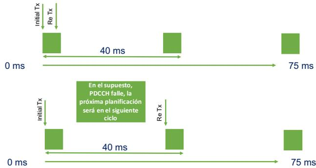
Figura 59: MCPTT & Tiempo de duración de la comunicación
