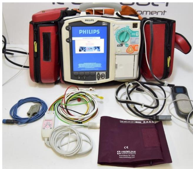
Ilustración 3: Monitor-desfibrilador Philips HeartStart MRx [23]
