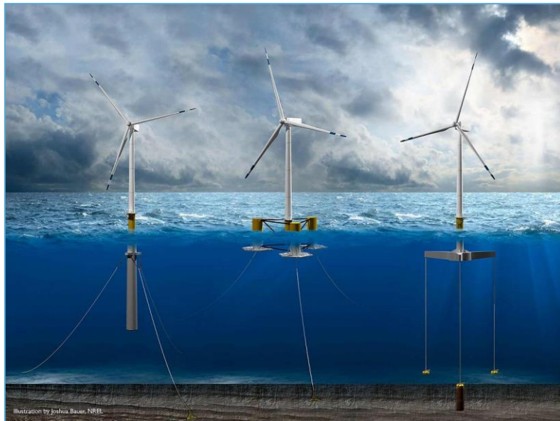
Figura 6: De izquierda a derecha: spar, semisumergible y TLP (ilustración de Joshua Bauer, NREL)
