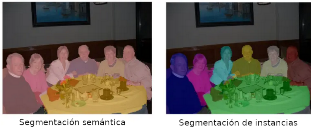
Figura 2.1: Segmentación semántica y segmentación de instancias. De izquierda a derecha: segmentación semántica aplicada a una imagen, y segmentación de instancias aplicada a la misma imagen. Fuente: [Arnab et al., 2018].
