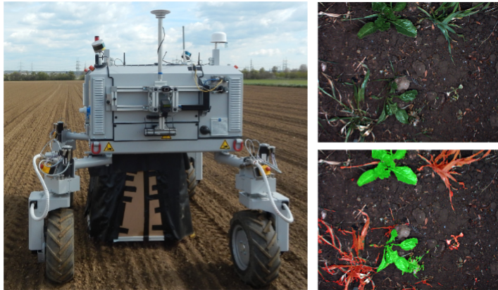
Figura 2.4: Aplicación de la segmentación semántica en robots agricultores. A la izquierda se encuentra el robot agricultor. En la zona superior derecha se encuentra la imagen obtenida por el robot, y debajo, la segmentación semántica extraída, clasificando diversas plantas. Fuente: [Milioto et al., 2018].
