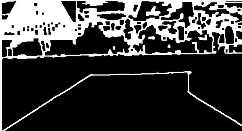
**Figura 6.18:** Operación morfológica de dilatación (3 iteraciones, kernel 3x3) seguida de una erosión (2 iteraciones, kernel 3x3)
