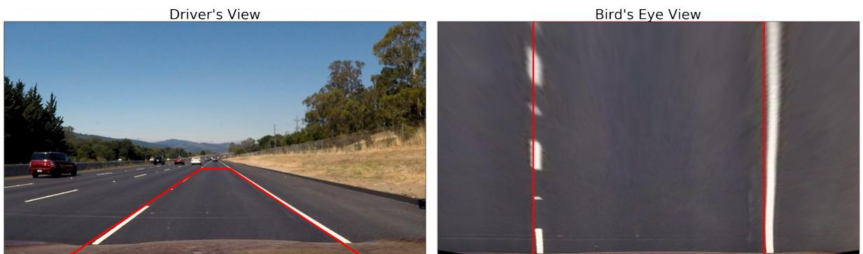
Figura 6.5: Transformación real de la perspectiva
