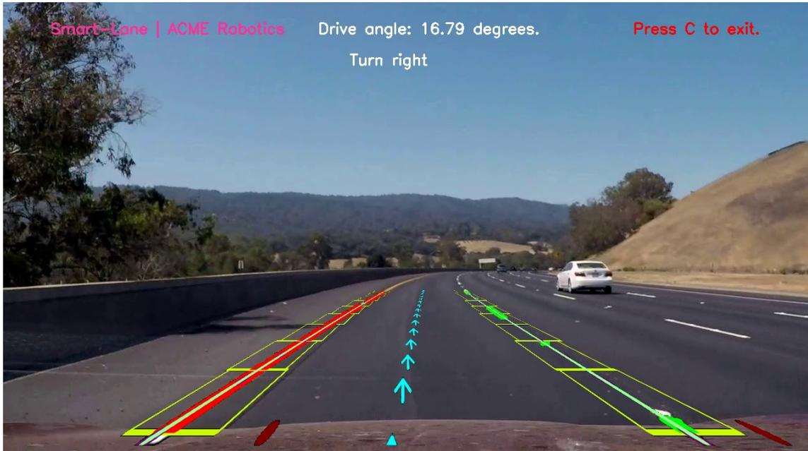
Figura 6.3: Vista obtenida de un programa encargado de interpretar las líneas de una carretera
