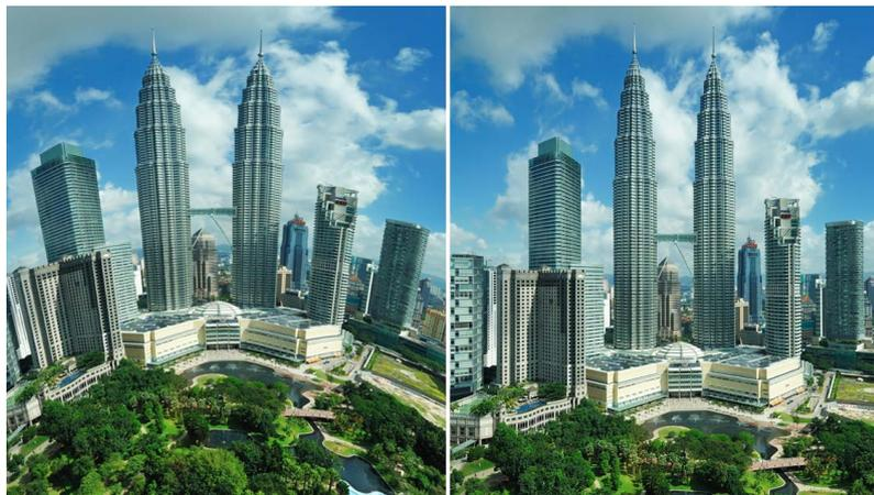
**Figura 5.1:** Distorsión producida por el objetivo de una cámara
