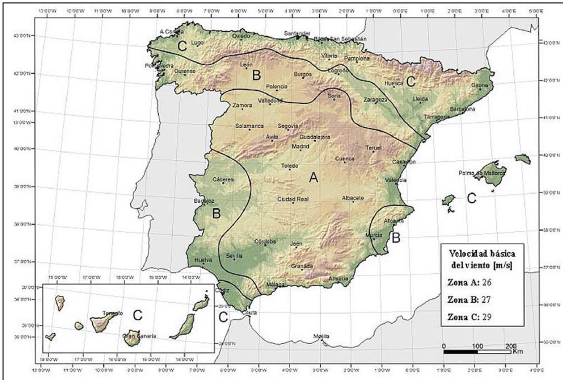
Ilustración 4. Mapa de isotacas para la obtención de  $v_{b,0}$ . Fuente: IAP-11
