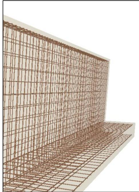
Ilustración 9. Modelo 3D de los muros. Fuente: CYPE 3D
