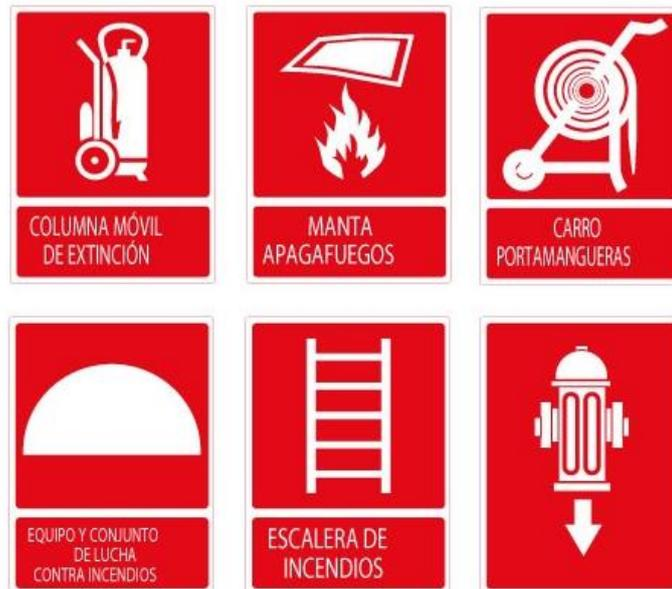
Ilustración 7. Ejemplos de señales de indicación. (Equipos contra incendios)
