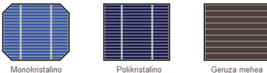
Irudia 13. Zelula monokristalinoa, polikristalinoa eta geruza mehekoa
