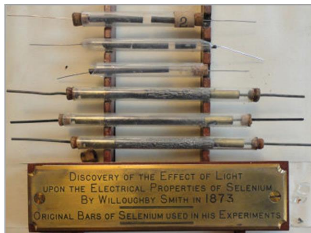
Irudia 1. Willoughby Smith-en esperimentuetan erabilitako selenioko barrak [18]
