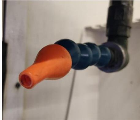
*Ilustración 31. Manguera de refrigeración y boquilla de sección circular*
