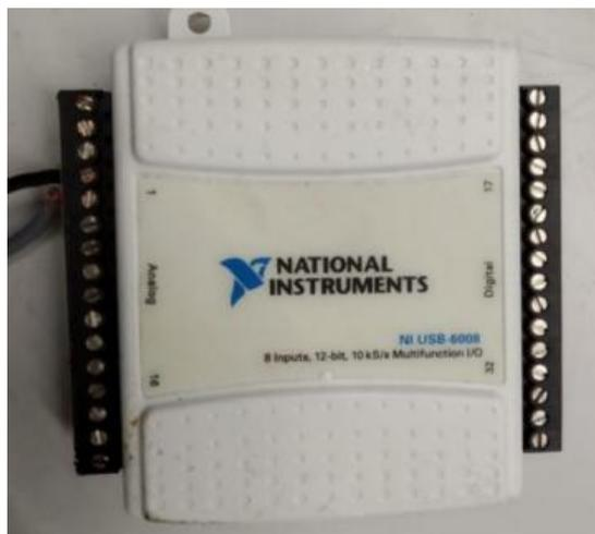
*Ilustración 42. Tarjeta de adquisición de datos USB-6008(National Instruments)*
