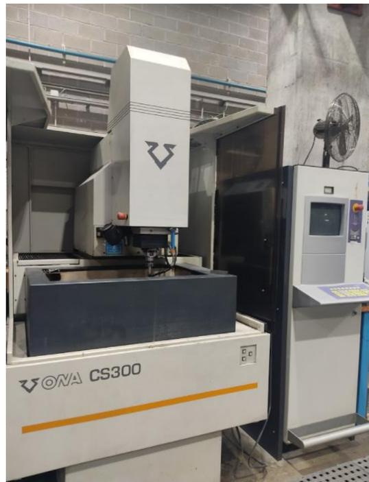
*Ilustración 34. Máquina de electroerosión por penetración ONA CS300*
