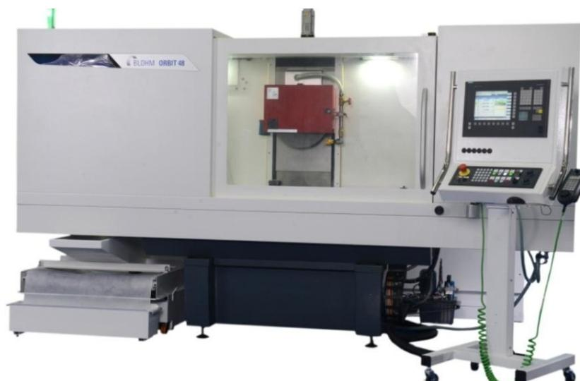
*Ilustración 39. Rectificadora plana BLOHM ORBIT 36*
