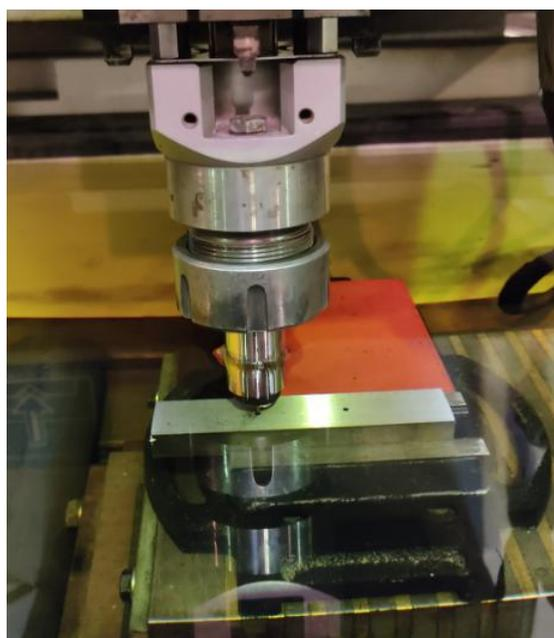
*Ilustración 51. Proceso de electroerosión por penetración*
