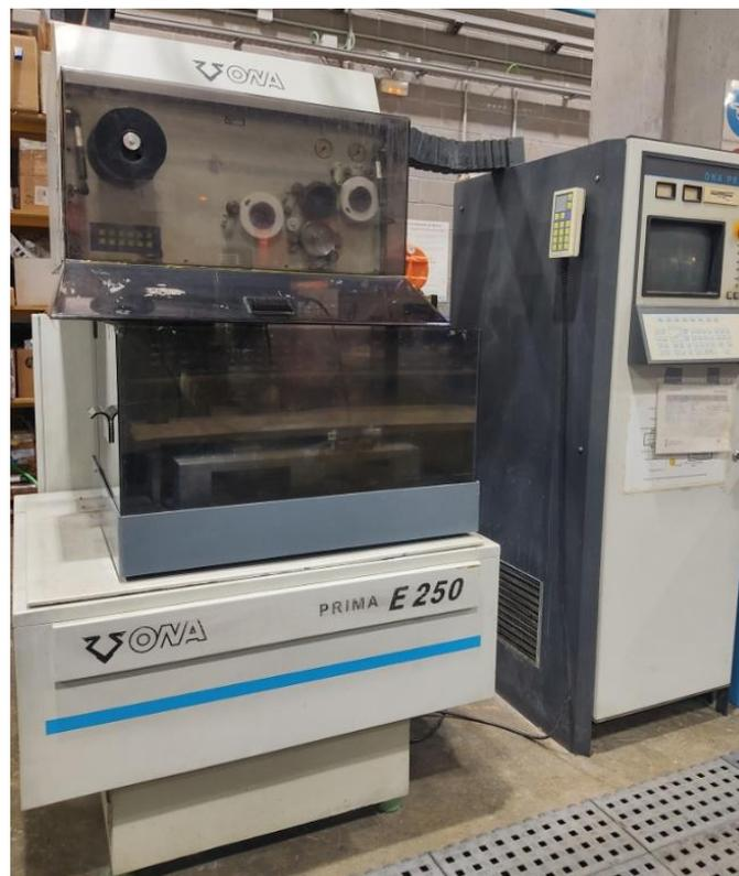
*Ilustración 46. Máquina de electroerosión por hilo*
