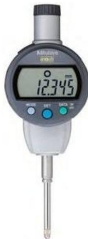
Ilustración 40. Reloj comparador. Fuente: Mitutoyo
