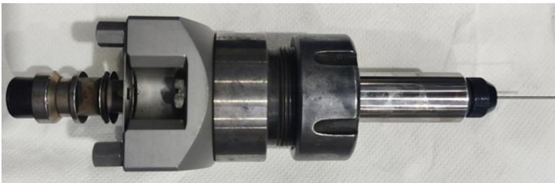
*Ilustración 35. Porta electrodos con electrodo de 1mm.*
