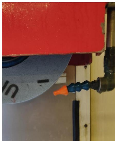
*Ilustración 64. Boquilla mal posicionada*
