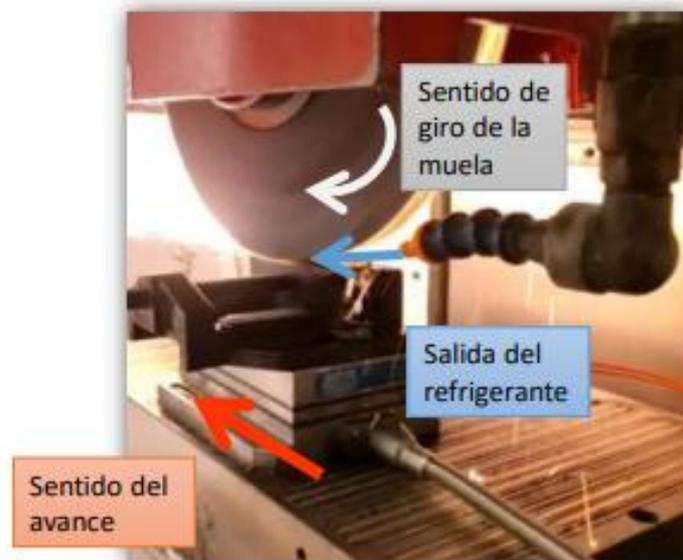
Ilustración 55. Configuración Down Grinding
