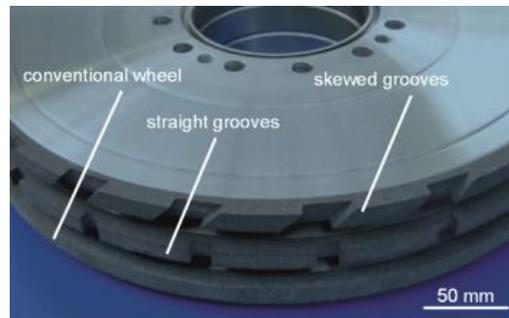
Ilustración 24. Muelas con ranuras para la refrigeración. Fuente [27]
