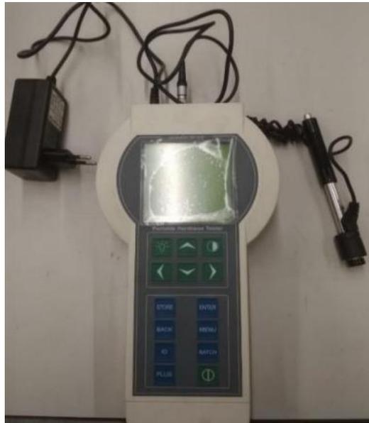
Ilustración 36. Durómetro
