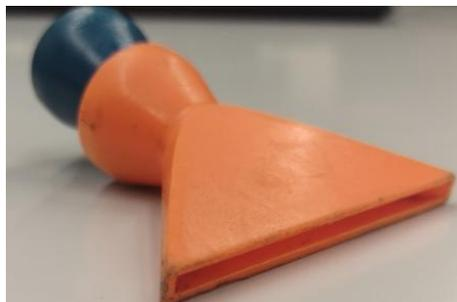
*Ilustración 32. Boquilla de sección rectangular*
