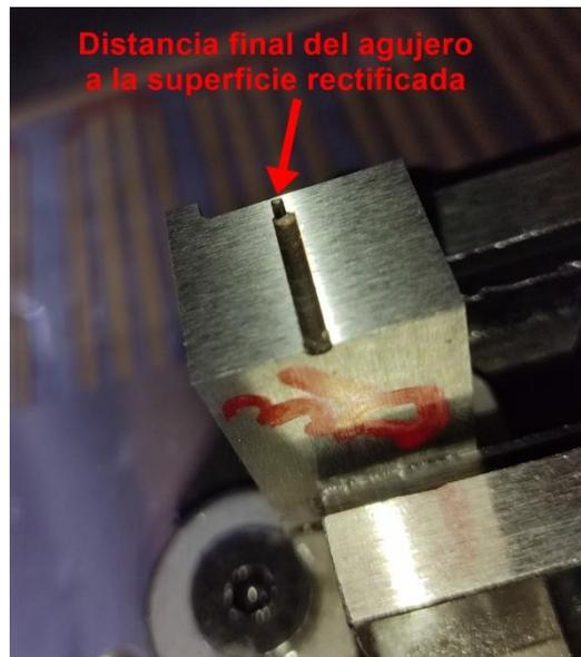
*Ilustración 67. Agujero descubierto por rectificado*
