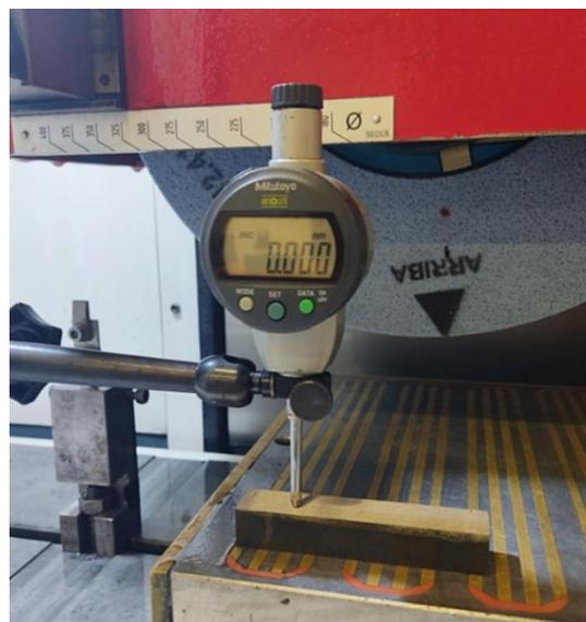
*Ilustración 53. Medición de la altura de la pieza*
