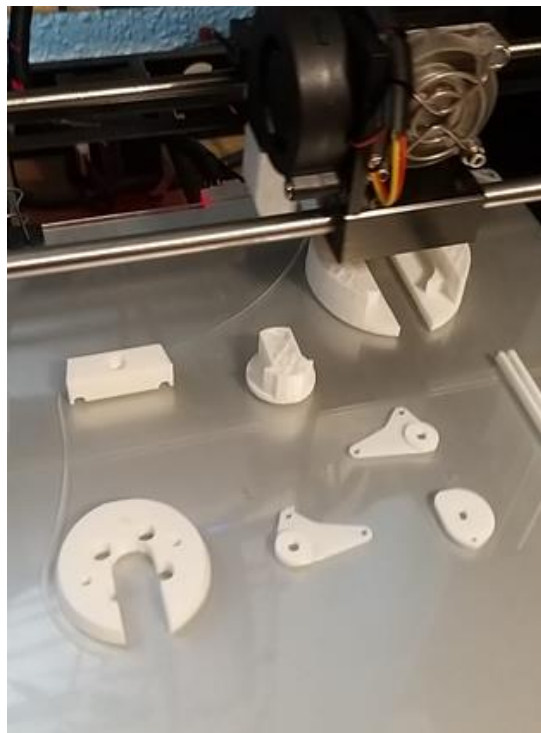
Ilustración 15: Impresora Anet A6 fabricando piezas del aeromodelo
