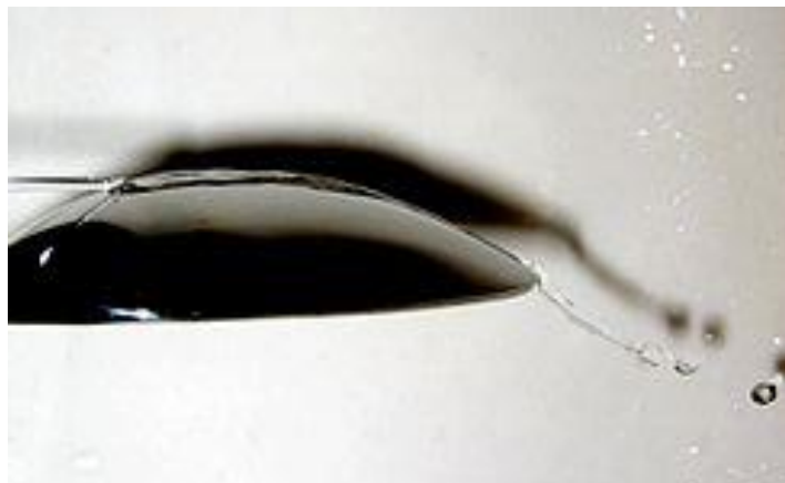
Ilustración 3: Efecto Coanda demostrado con una cucharilla y agua.
