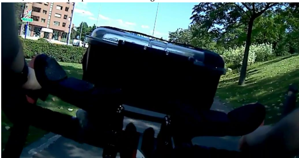
Ilustración 45: Experimento dinámico con bicicleta. Se puede observar la caja que contiene la electrónica encima de las aerobarras
