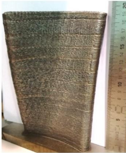
Figura 117. Pieza de demostración de la aplicación del control de altura en el proceso LMD-P.
