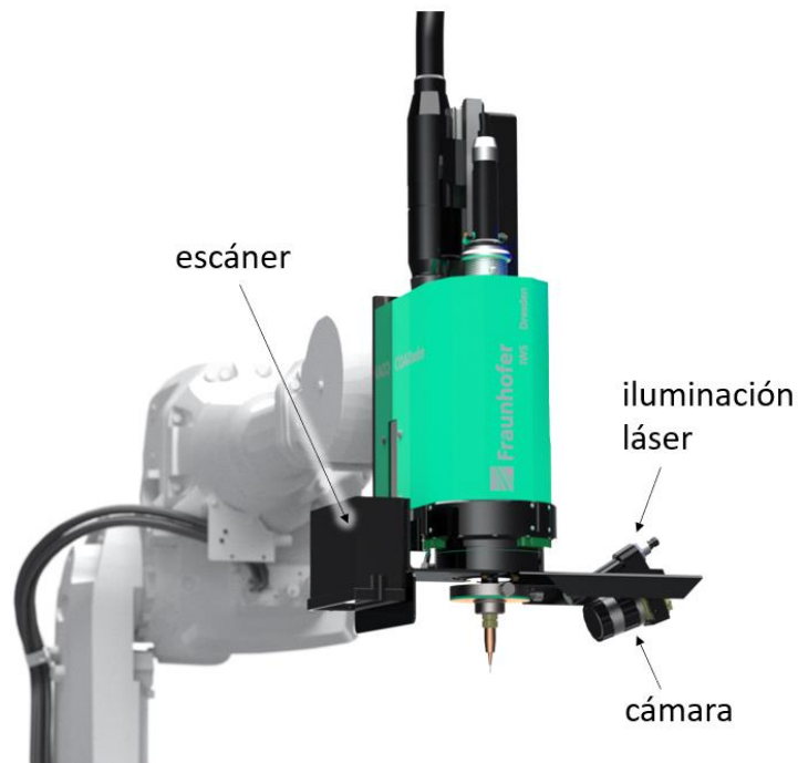
Figura 53. Sistema de monitorización fijado en el cabezal de aporte, con escáner de luz estructurada GOCATOR 3109, cámara de visión e iluminación láser.
