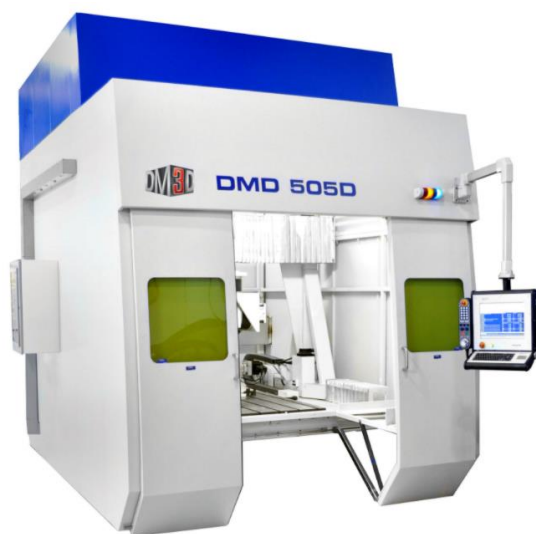
Figura 42. Máquina de LMD-P DMD 505D de la empresa DM3D Technology [54].
