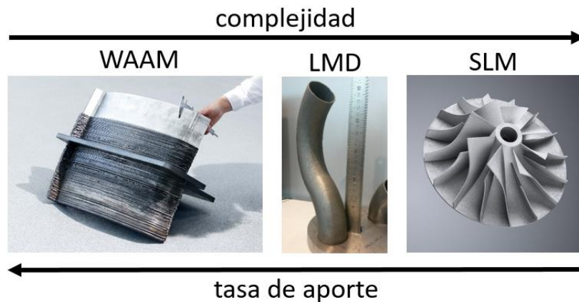
Figura 10. Piezas fabricadas por diferentes tecnologías de FA metálica. Pieza fabricada por Addilan mediante la tecnología WAAM [17], LMD por Tekniker y SLM por Trumpf [24].
