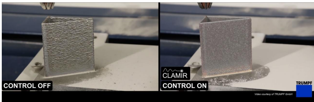
Figura 7. Pieza fabricada sin control y mediante el sistema de control CLAMIR [9].
