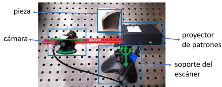
Figura 51. Escáner de luz estructurada HP SLS3.
