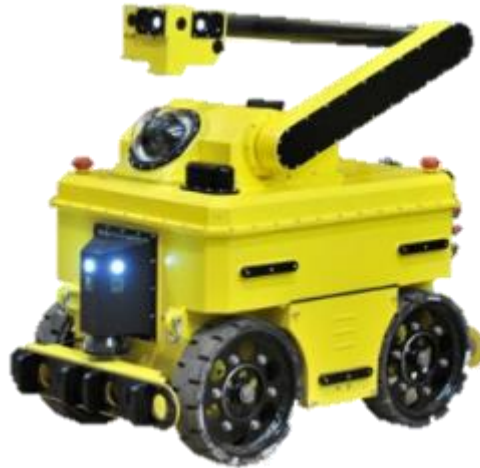
Ilustración 14. Robot de la empresa Petrobot para inspección y mantenimiento
