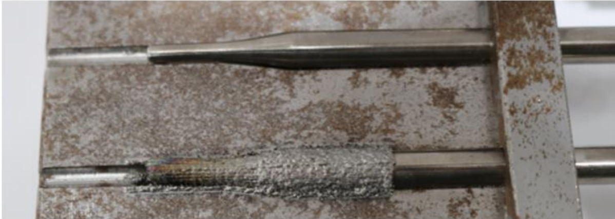
Ilustración 78. Termopar integrado en el sustrato.
