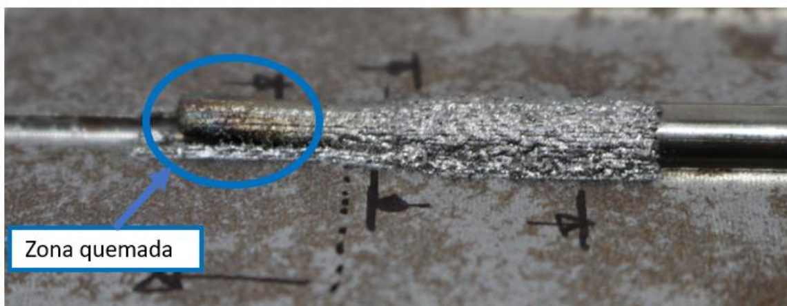
Ilustración 79. Defectos en la integración del termopar I.
