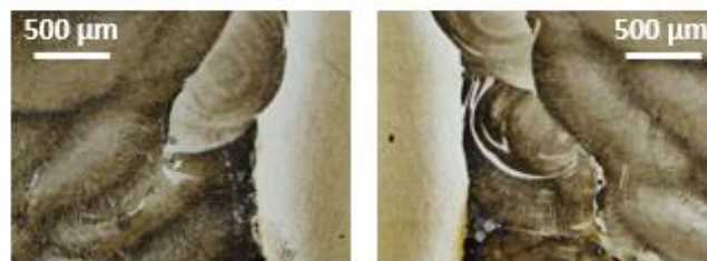
Ilustración 65. Zonas críticas de penetración insuficiente.
