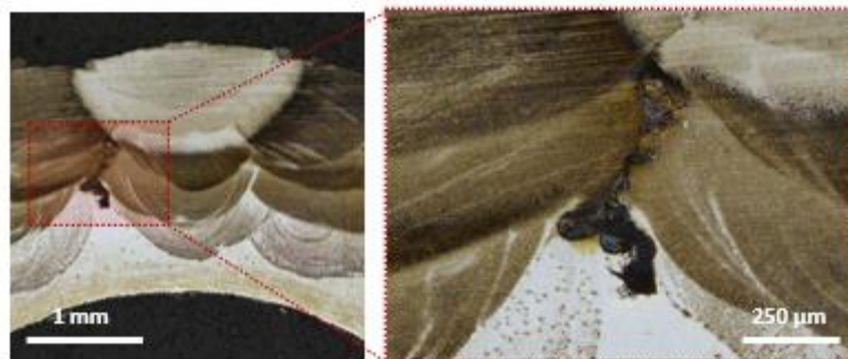
Ilustración 59. Grieta en la zona superior del cable de diámetro Ø8.
