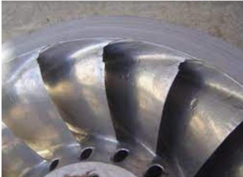
Imagen 32. Erosión por cavitación en los alabes de turbina. [45]
