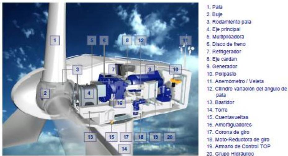
*Figura 6. Componentes principales del aerogenerador HAWT [8].*
