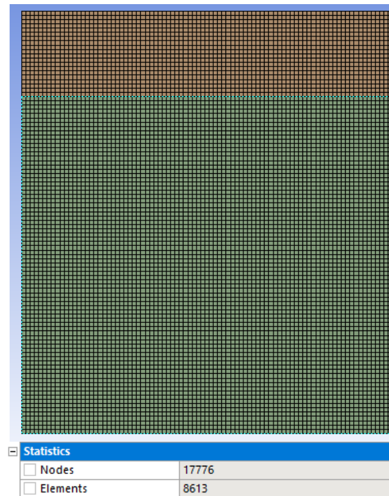
Imagen 81: El mallado del paralelepípedo
