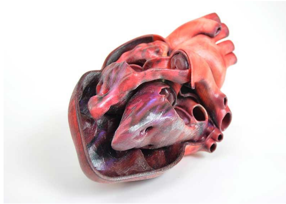
Imagen 24: Objeto impreso por inyección de material
