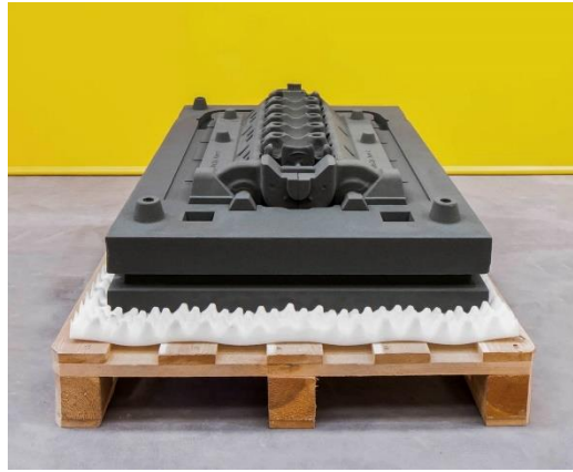
Imagen 29: Moldes de arena impresos por “Binder Jetting”
