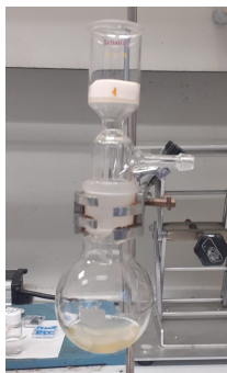
Figura 11: Columna de \text{Al}_2\text{O}_3 neutro para filtración del polímero.
