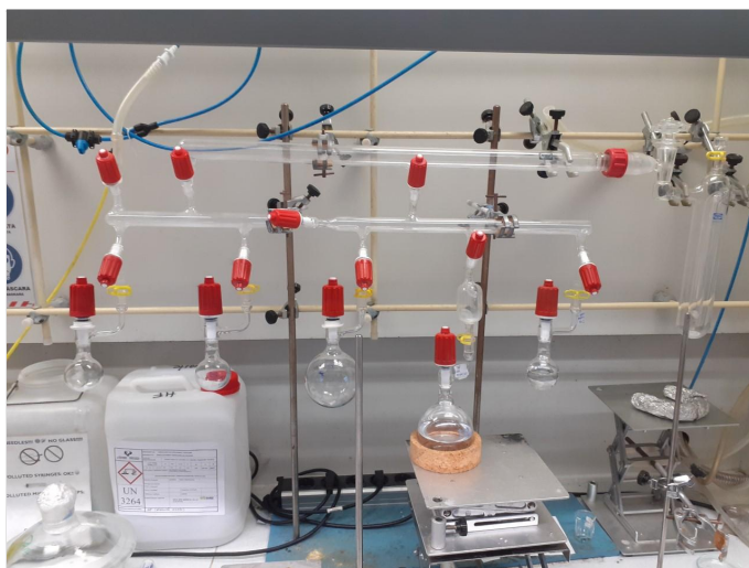
Figura 10: Línea de vacío y matraces especiales utilizados para la destilación del THF
